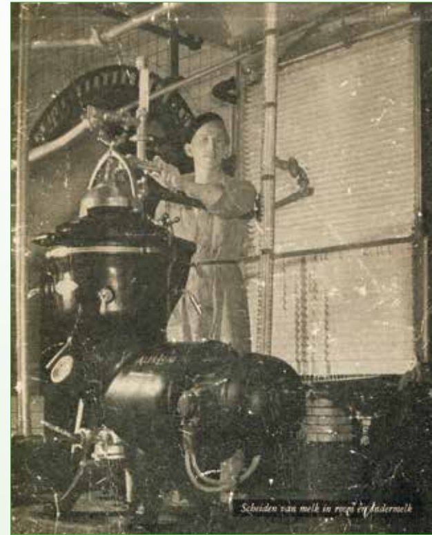
Scheiding van room en ondermelk rond 1935 met behulp van een Laval-centrifuge in de fabriek van Nutricia. De 'centrifugist' is Wim Klos
