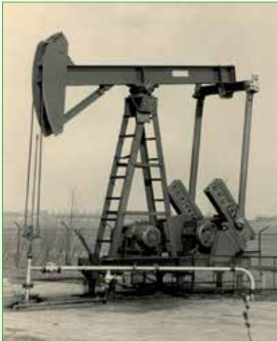
E n van de drie jaknikkers van de eerste lichting in Zoetermeer (1957-1958), een Thomassen type 730 CE. Zeer waarschijnlijk Meerpolder ZOM-01 of ZOM-02
