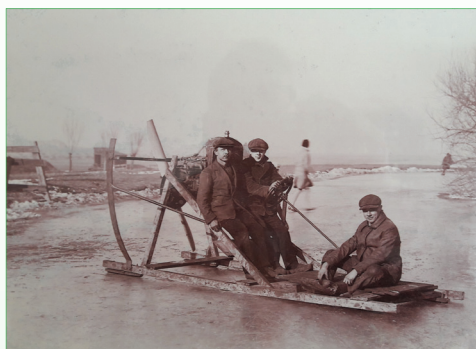
De motorisch aangedreven ijslee, ontworpen door Dirk Franx
