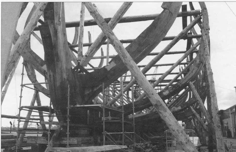
De voorsteven van een replica van de Delft in aanbouw
